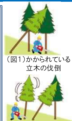
(図2) かかり木に激突させるためにかかり木以外の立木の伐倒
